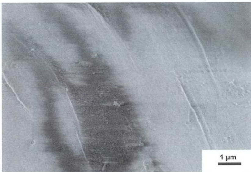
Abbildung 30: REM Aufnahme der Faseroberfläche. Bei dieser Vergrößerung wurden ungleichmäßig verteilte Anhaftungen sichtbar.
