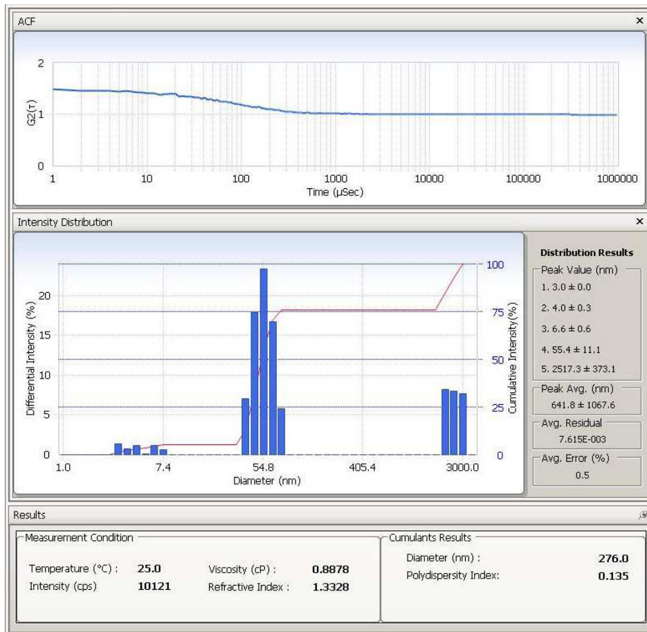
Abbildung 22: Ausgabe der DelsaNano Geräte Software der ersten DLS-Einzelmessung der Probe NM-300K in AAP-Medium am Tag 0. Oben ist die Autokorrelationsfunktion des gestreuten Lichts, in der Mitte die mit dem NNLS-Algorithmus bestimmte Größenverteilung und unten die Messbedingungen mit den Ergebnissen der Kumulanten-Methode.
