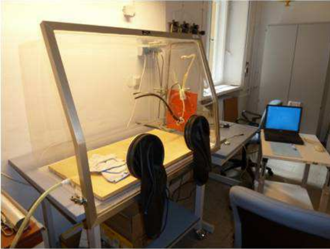
Abbildung 6: Versuchsaufbau für die Untersuchungen zur Partikelfreisetzung von Ag-NP aus Wischtüchern (eingebaute Oberfläche: Naturholzplatte).
