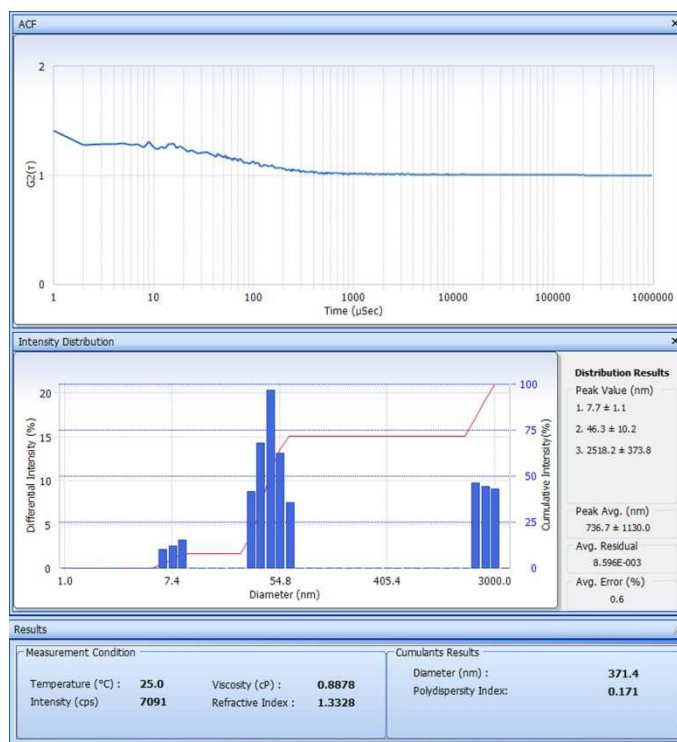
Abbildung 16: Ausgabe der DelsaNano Geräte Software der ersten DLS-Einzelmessung der Probe NM-300K in D. rerio . Medium am Tag 1. Oben ist die Autokorrelationsfunktion des gestreuten Lichts, in der Mitte die mit dem NNLS-Algorithmus bestimmte Größenverteilung und unten die Messbedingungen mit den Ergebnissen der Kumulanten-Methode.
