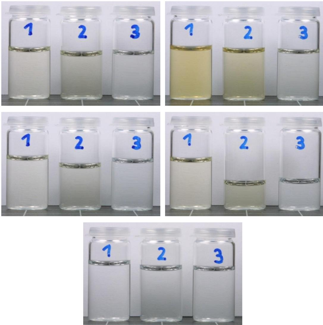
**Abbildung 21:** Bodeneluat nach den Aufreinigungsschritten mit (1) 0,45  $\mu\text{m}$  MCE-, (2) 0,1  $\mu\text{m}$  PVDF-Spritzenfilter und (3) 3000 dalton Zentrifugenkonzentrator; links ob.) Refesol, rechts ob.) Gley, links mi.) Gley-Podsol, rechts mit.) Parabraunerde und unten) Parabraunerde Haftenäsepsudogley
