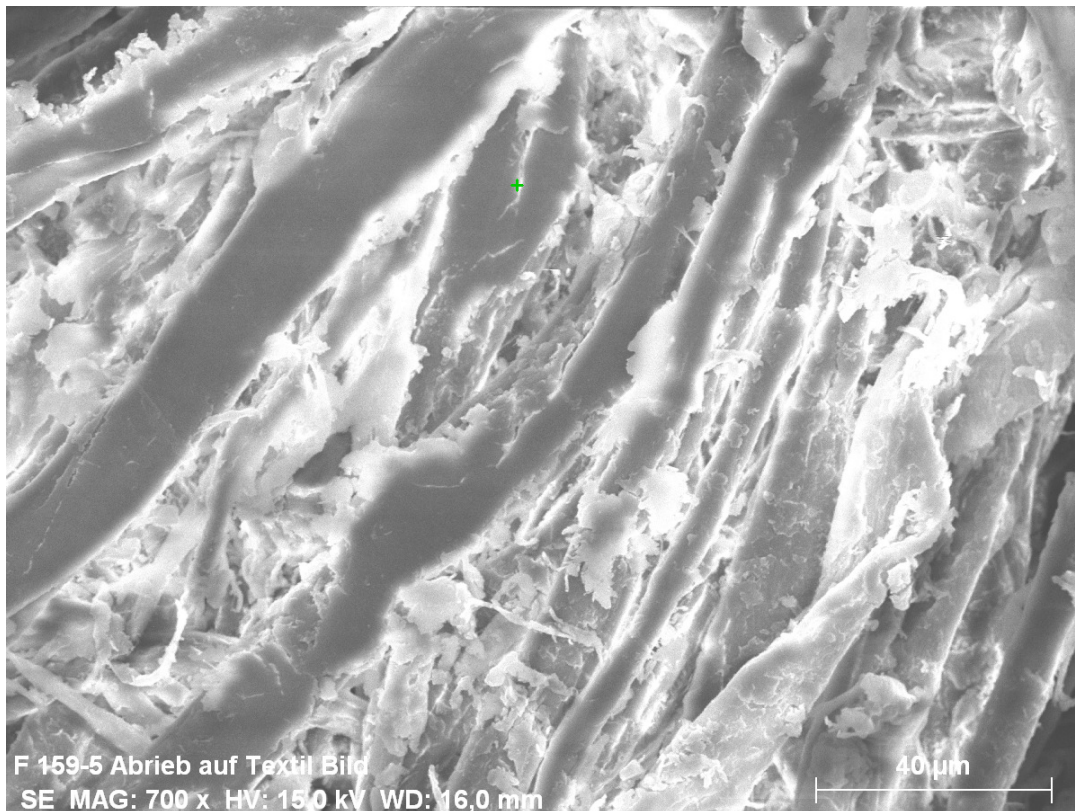
Abb. 30 a): Grober Abrieb (Liegestaub) der voll ausgerüsteten Baumwolle (02/2012), REM, 700x, Sekundärelektronen-Detektor
