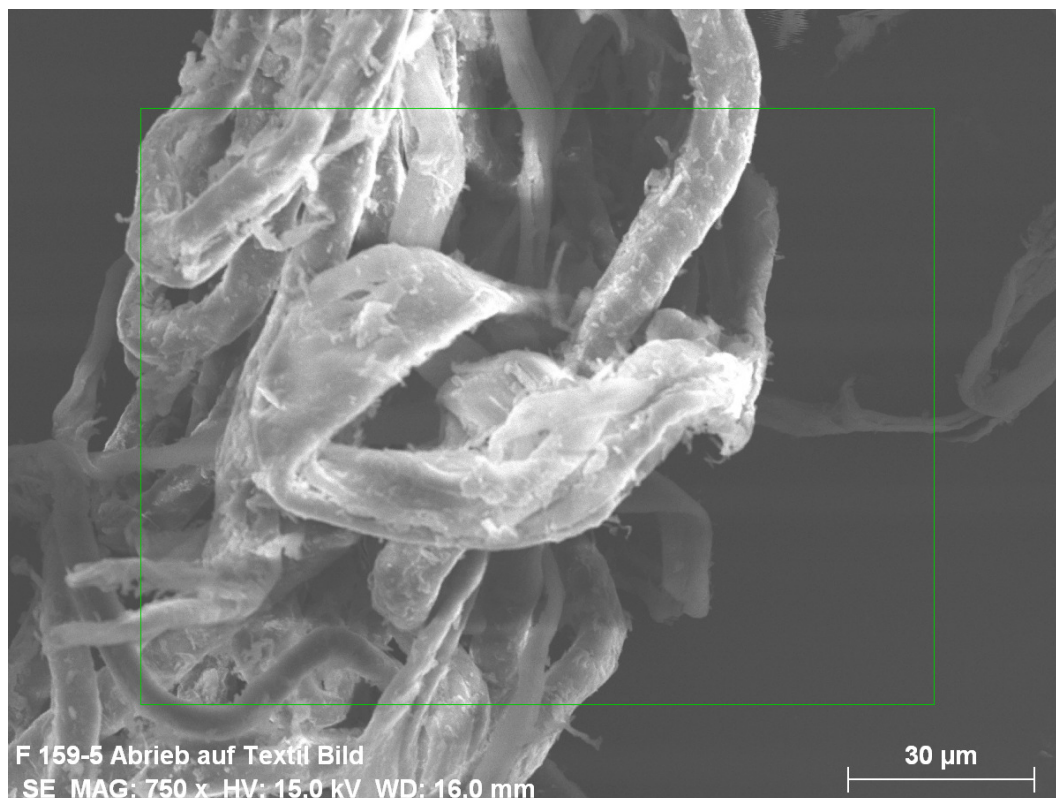
Abb. 29 a): Grober Abrieb (Liegestaub) der voll ausgerüsteten Baumwolle (02/2012), REM, 750x, Sekundärelektronen-Detektor
