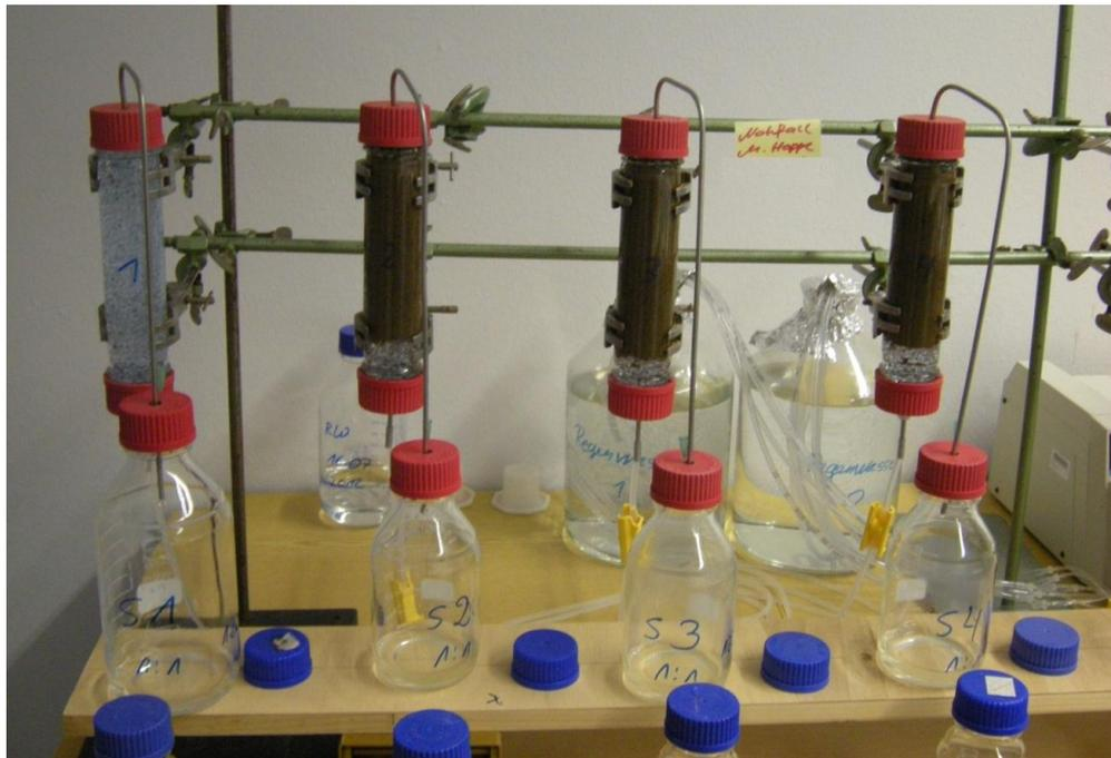
Abbildung 26: Versuchsaufbau bei der Elution von Bodensäulen
