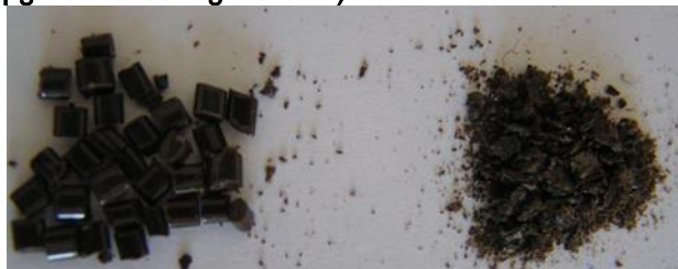
Abbildung 2: Polyethylenterephthalat (PET)-Masterbatch (aus AP 3.1) - links- vor der Probenvorbereitung -rechts- nach der Probenvorbereitung.
