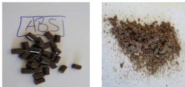
Abbildung 6: ABS-Masterbatch (aus AP 3) -links- vor der Probenvorbereitung -rechts- nach der Probenvorbereitung: Der Kunststoff konnte durch langes Schmelzen und anschließendem Mörsern in flüssiger Stickstoffatmosphäre zerkleinert werden. Die Größe der erhaltenen Kunststoffteilchen beträgt < 0,5 mm.
