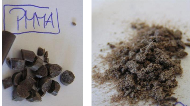
Abbildung 5: Polymethylmethacrylat (PMMA) -links- vor der Probenvorbereitung -rechts- nach der Probenvorbereitung: Der Kunststoff konnte durch Schmelzen und anschließendem Mörsern in flüssigem Stickstoff gut zerkleinert werden. Die Probe erschien nach diesem Vorbereitungsschritt fast staubartig.
