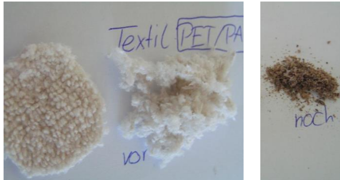
Abbildung 9: PET/PA-Textil -links- vor der Probenvorbereitung -zentral- nach Grobzerkleinerung -rechts- nach der Probenvorbereitung: Das Textil wurde grob vorzerkleinert, bis das Material faserig erschien. Anschließend konnte der Kunststoff durch Schmelzen und anschließendem Mörsern in flüssigem Stickstoff gut zerkleinert werden. Die Probe erschien nach dem Vorbereitungsschritt fast staubartig.
