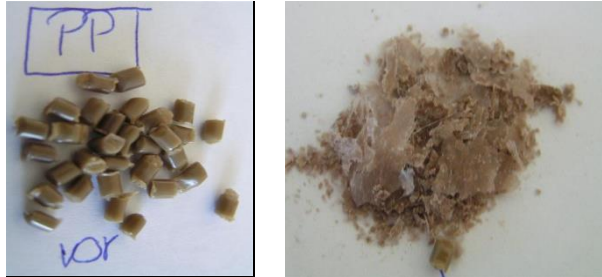
Abbildung 7: PP-Masterbatch -links- vor der Probenvorbereitung - rechts- nach der Probenvorbereitung: Der Kunststoff konnte durch Schmelzen und anschließendem Mörsern in flüssigem Stickstoff mäßig gut zerkleinert werden. Das Ergebnis beinhaltet flächig schuppige und pulverartige, kleine Komponenten, die nicht mehr weiter zerkleinert werden konnten.
