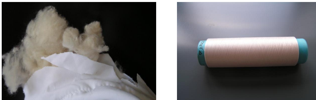
Abbildung 17: Links nanosilberhaltige PET-Stapelfaser, rechts nanosilberhaltiges PET-Garn, Nanosilber in Faser eingearbeitet
